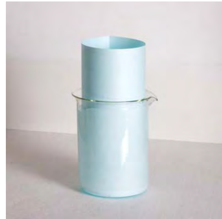
Abb. 20 Tauchen eines geformten Papiers in eine Prüflüssigkeit
