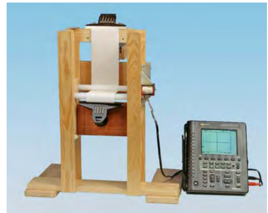
Abb. 27 Triboelektrik - Fallschlitten nach Ehrler und Oszilloskop
