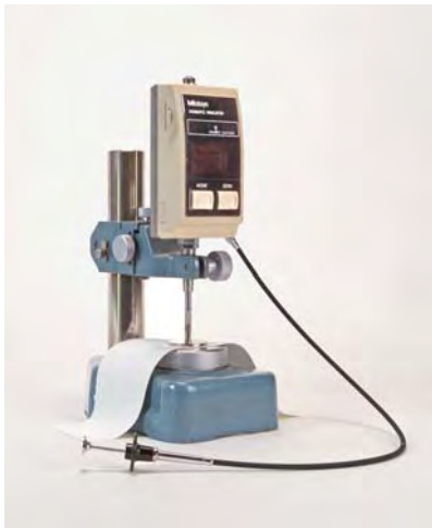
Abb. 01 elektr. Dickenmessgerät für textile Flächengebilde und Papier, Mitutoyo
