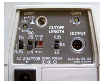
Abb. 04, 05 Surftens Messgerät für die Oberflächenrauigkeit, links mit Kalibriernormal, Mitutoyo
