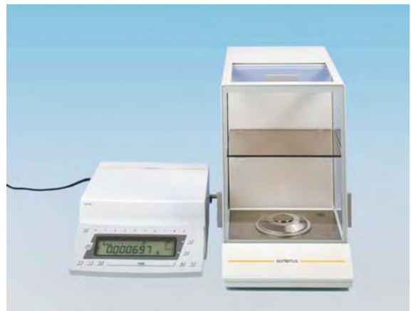
Abb. 02 Präzisionswaage zur Messung der flächenbezogenen Masse, Sartorius
