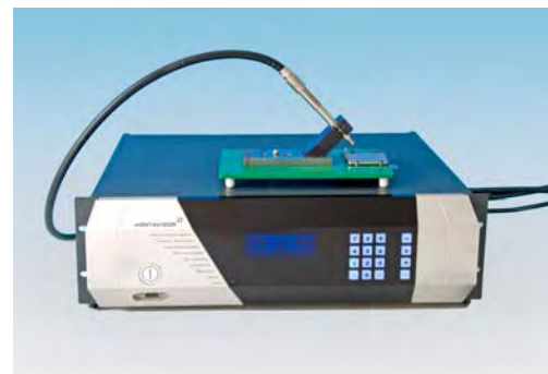
Abb. 37 Kontavisor, Systekum GmbH, Kiel Laser-Fluoreszenz-Dickenmessung dünner Ölschichten
