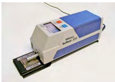
Abb. 04, 05 Surftens Messgerät für die Oberflächenrauigkeit, links mit Kalibriernormal, Mitutoyo
