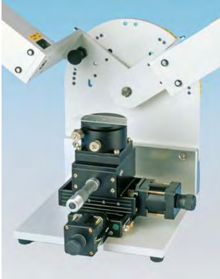
Abb. 34 Dr. Riss - Ellipsometer für die Dickenmessung extrem dünner, transparenter Verunreinigungsschichten im nm-Bereich (Beispiele Abb. 35, 36)
