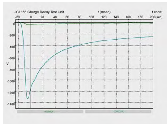
Abb. 30 Ladungs-Zeit-Diagramm einer Textilprobe nach einer Messung im Entladungs-Messgerät nach Chubb
